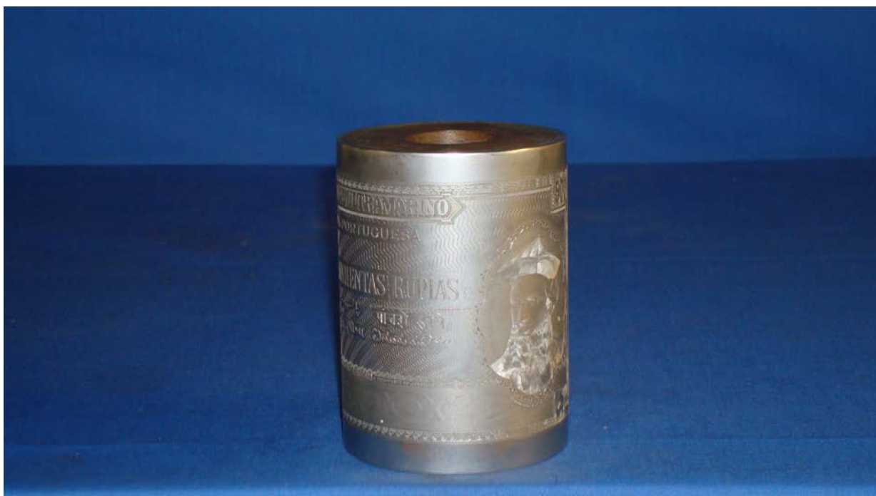
1. Cilindro compressor para frente da nota de 500 Rupias da Emissão Afonso de Albuquerque de 1945, BNU Índia
